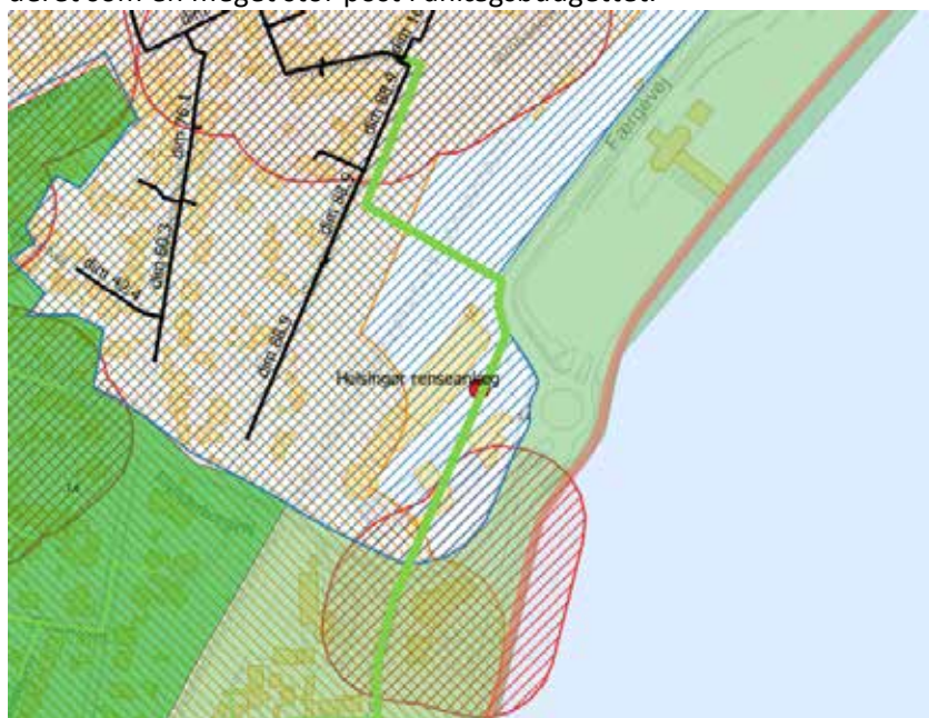
FIGUR 5: PLOT FRA GIS MED INDTEGNET STØJGRÆNSER FOR BEBOELSE/ANDET, NUVÆRENDE OG FREMTIDIGE FJV OMRÅDER NUVÆRENDE OG PLANLAGTE FJERNVARMELEDNINGER.
